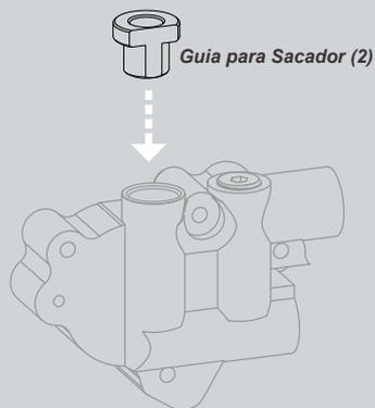
OBS: Quando aplicado o guia(2), atente-se para que o lado do fresado fique direcionado para o ressalto raiado que existe na bomba.
