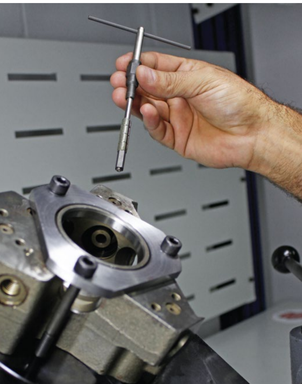
Desbaste e Acabamento do Alojamento do Elemento das Bombas de Alta Pressão
