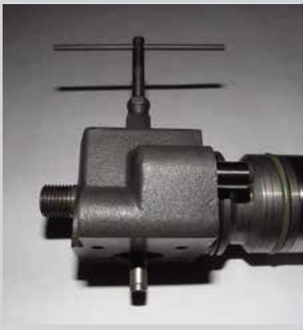
**2** Caso não exista contato, apoie a haste cônica sem a manopla em uma base firme e tencione a bucha cônica (5) através de impacto.
