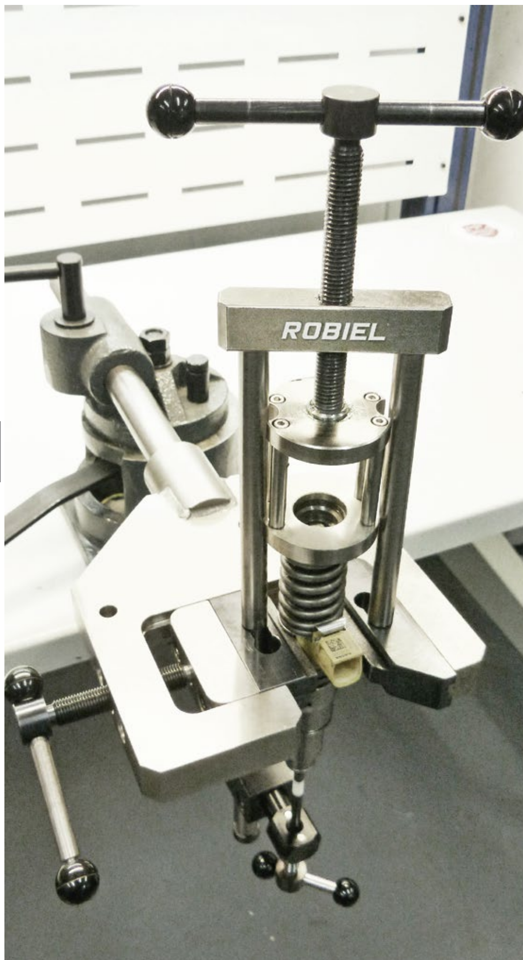
Dispositivo de Compressão da Mola e Remoção da Válvula da Unidade Delphi
